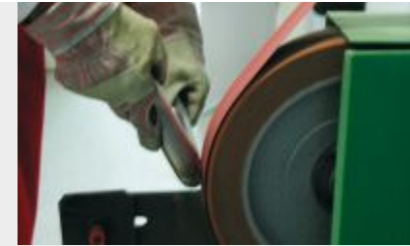
Obróbka wykańczająca stali nierdzewnej
