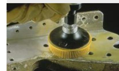
Usuwanie powłok malarskich
