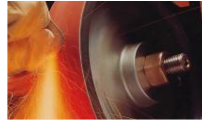
Obróbka zgrubna stali nierdzewnej
