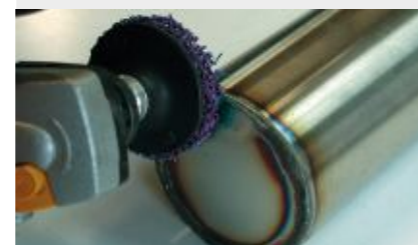
Czyszczenie zgrzewów i przebarwień
