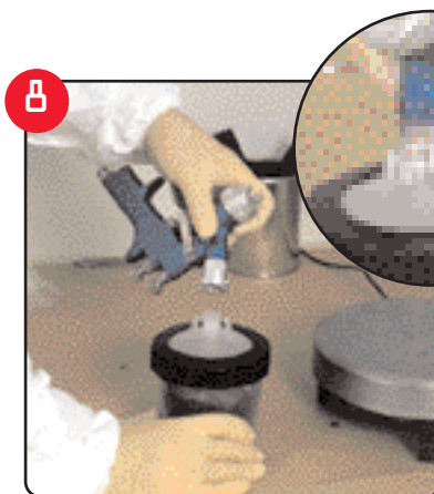
Odwrócić pistolet i zamocować do kubka.
