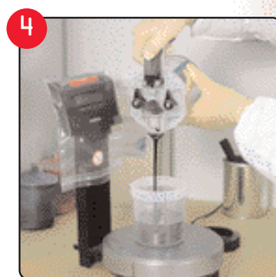
Skontrolować ilość lakieru za pomocą skali na kubku, bądź wagi.
