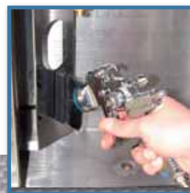
Czyszczenie dyszy szczotką [ air cap cleaning with strip ]
