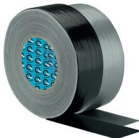
10-190 to taśma tkaninowa o dużej wytrzymałości, wykorzystująca wodoodporny i wysokowydajny klej. Stosowana jest głównie jako ochrona krawędzi części karoserii podczas procesów szlifowania, ale może być również używana podczas piaskowania. Podłoże wykonane z laminatu z tkaniny polietylenowej, klej na bazie gumy. Całkowita grubość to 30 my.
