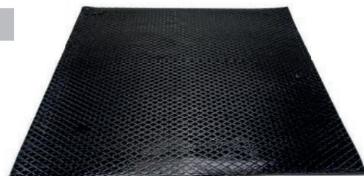
50-500 to samoprzylepna bitumiczna mata tłumiąca na bazie wysokiej jakości bitumu modyfikowanego polimerami i specjalnych wypełniaczy. Dzięki dobrej elastyczności w temperaturze pokojowej mata dobrze dopasowuje się nawet do wybrzuszeń. Mata jest samoprzylepna z klejem niezawierającym rozpuszczalników.
