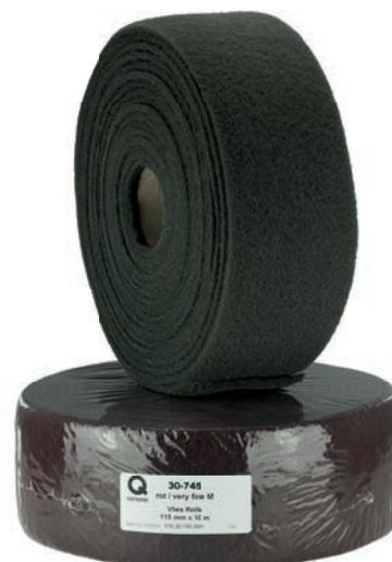
30-745 to włóknina ścierna do matowania powierzchni przed lakierowaniem. Bardzo elastyczna, do użytku na sucho i na mokro. Nośnik jest włókniną, ziarno ścierna to tlenek glinu / węgiel krzemu.
