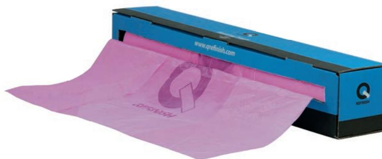
10-145 to profesjonalna, wysokojakościowa folia maskująca przyciągająca zakurz lakierniczy, przeznaczona do stosowania w lakierniach samochodowych. Ze względu na ładunek elektrostatyczny folia maskująca przylega idealnie do karoserii samochodu, jednocześnie wiążąc nadmiar farby. 10-145 w pewnym stopniu pochłania wilgoć ze względu na jej wypełnienie węglanem wapnia. Folia ma grubość 14 my i jest odporna na temperaturę do 110 ° C. Odporna na IR.
