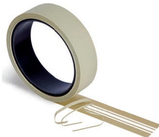
10-180 to wstępnie nacięta, elastyczna taśma cienkoliniowa, składająca się z 8 odcinków po 1,5 mm każdy, które można oddzielnie zrywać. Idealna do różnych linii wzorniczych, zakrzywionych i prostych. Odporna na temperaturę do 138° C. Podłoże wykonane jest z PP, klej jest na bazie PU i jest wrażliwy na nacisk. Całkowita grubość wynosi 127 my.
