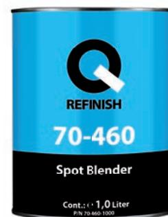
70-460 to specjalna mieszanka rozpuszczalników (blender punktowy) do rozpuszczania lakieru podczas miejscowych napraw i przejść. Może być również stosowany do rozpuszczania istniejącej starej farby, a także do poprawy przyczepności pośredniej do następnej powłoki. W związku z tym należy go równomiernie nałożyć na istniejącą starą farbę i zamalować w ciągu kilku minut.
