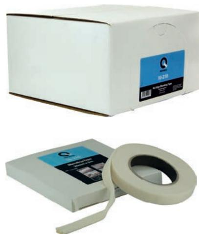
10-210 to połączenie taśmy maskującej i pianki, aby uniknąć twardych krawędzi lakieru między starym a nowym lakierem. Odporna na temperaturę do 120 ° C i podczerwień. Nośnik jest wykonany z nasyczonego pół krepowanego papieru pokrytego pianką PU, klej na bazie gumy. Całkowita grubość to 30 my.
