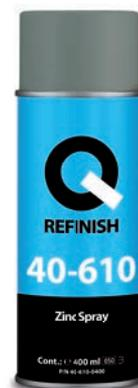
40-610 to metaliczny wysoce skuteczny podkład antykorozyjny na bazie cynku. Wysoka zawartość cynku zapewnia długotrwałe uszczelnienie i wysoką ochronę antykorozyjną, nawet w temperaturach powyżej 400 ° C. Produkt nadaje się szczególnie do wszystkich części samochodowych, których nie wolno malować, np. układy wydechowe, spawy, części ocynkowane oraz wewnętrzną stronę karoserii.
