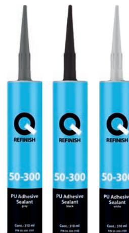
50-300 to bardzo wytrzymały, szybko schnący jednoskładnikowy poliuretan. Po utwardzeniu pozostaje elastyczny i bardzo dobrze przylega. Używany w branży motoryzacyjnej, morskiej i budowlanej / montażowej do klejenia PVC, drewna, PC, PBTO, PU, betonu, szkła i metalu. Masę tę można lakierować, dobra odporność na promieniowanie UV, nie kurczy się.
