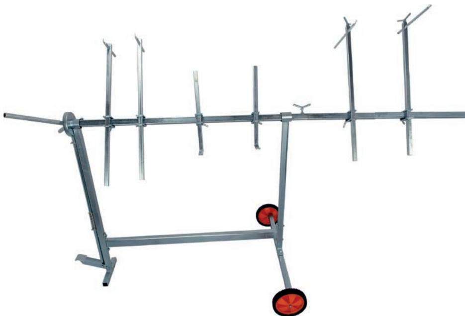
90-100 to ruchomy i obrotowy stojak do drzwi, masek samochodowych oraz innych elementów karoserii.
